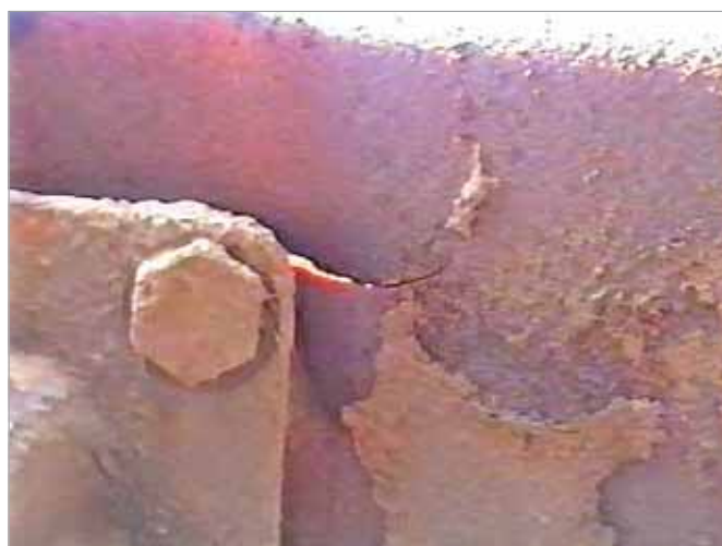
Obr. 3 Pohled na únavové trhliny podélného rámu.
