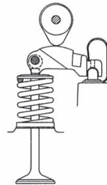
Obr. 14 Rozvodová páka (jednoramenné vahadlo) u rozvodu OHC nebo DOHC.
