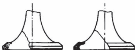
Obr. 7 Hlava (talíř) ventilu s indukčně tvrzeným (vlevo) a kaleným (vpravo) sedlem ventilu. Pro zmenšení opotřebení může být na sedlo navařen stelit (tvrdokov).
