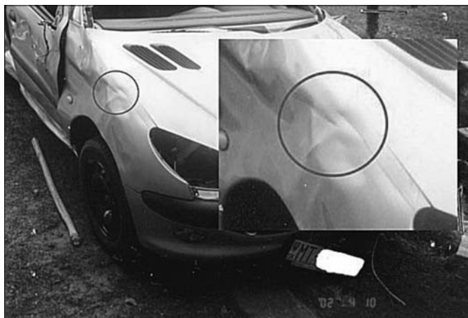
Obr. 2 Dve pozdĺžne orientované čiarovité deformačné poškodenia (taktiež viď zväčšený detail)
