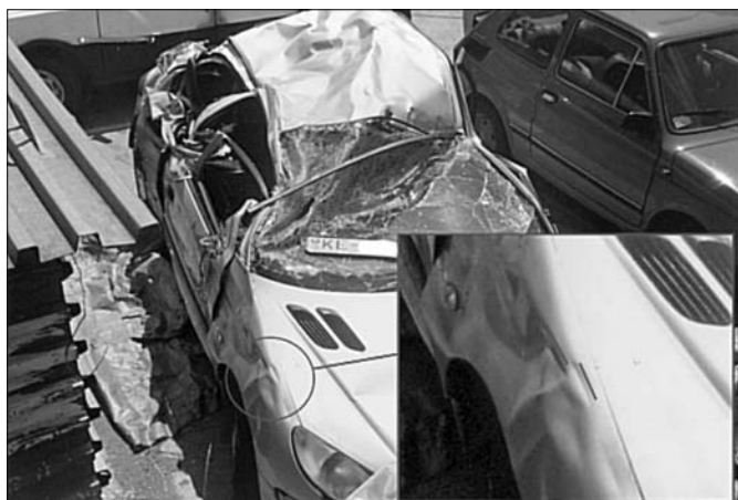
Obr. 1 Pozdĺžne orientované čiarovité deformačné poškodenia
