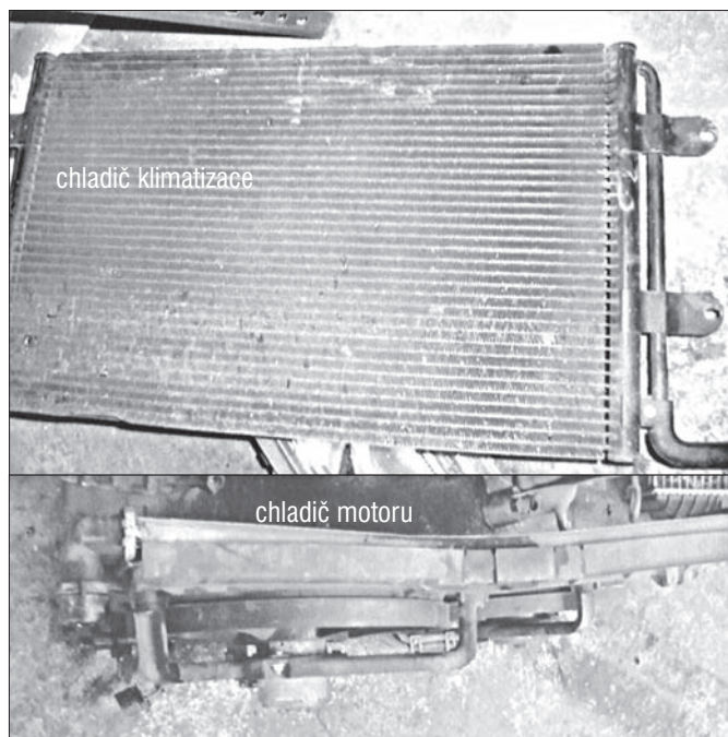
Obr. 8 Deklarované poškozené díly již demontované z vozidla
